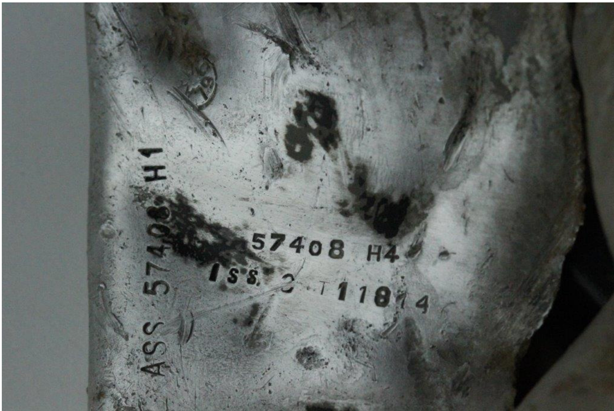
Aluminiumsstykke med fabrikationsnumre/inspektionsstempler.
