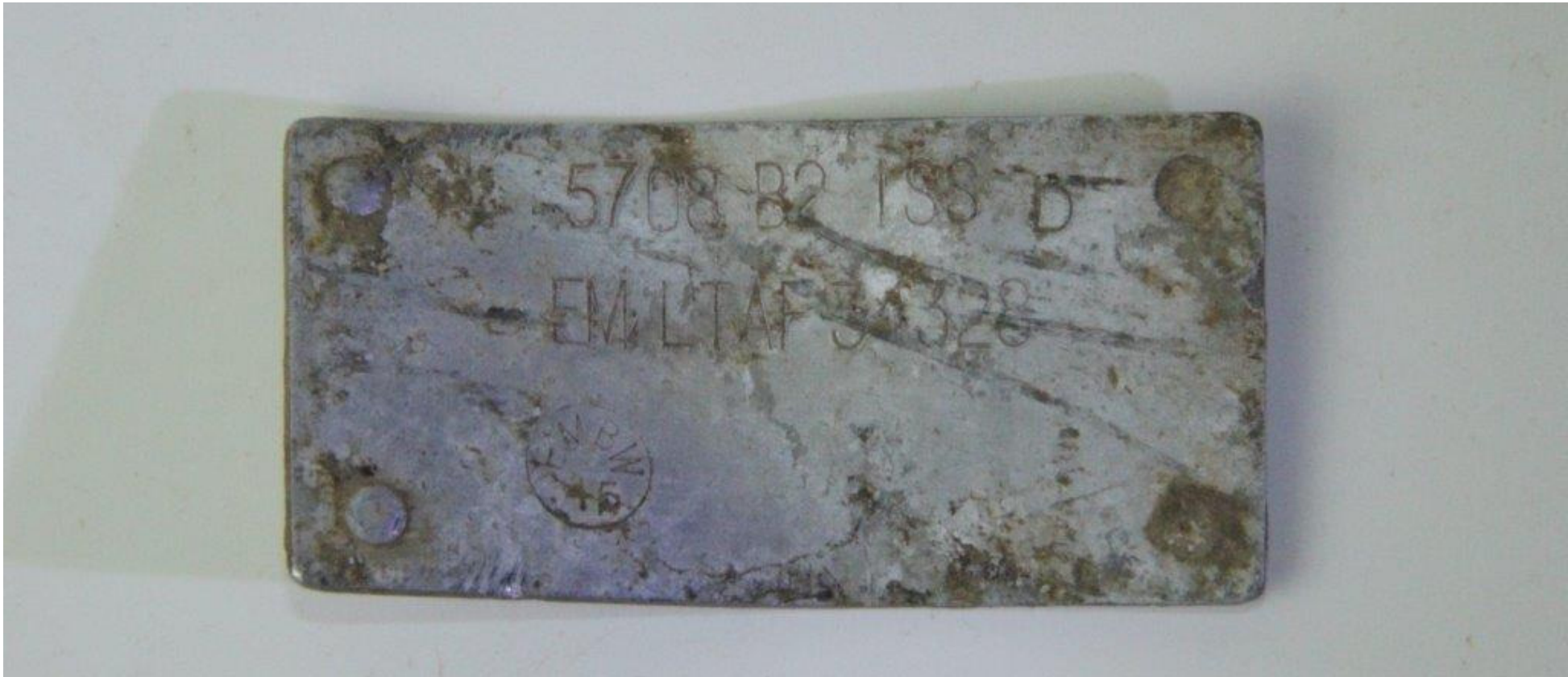
Vragdelsfelt 1: Aluminiumsplade med fabrikationsnumre og inspektionsstempler.
