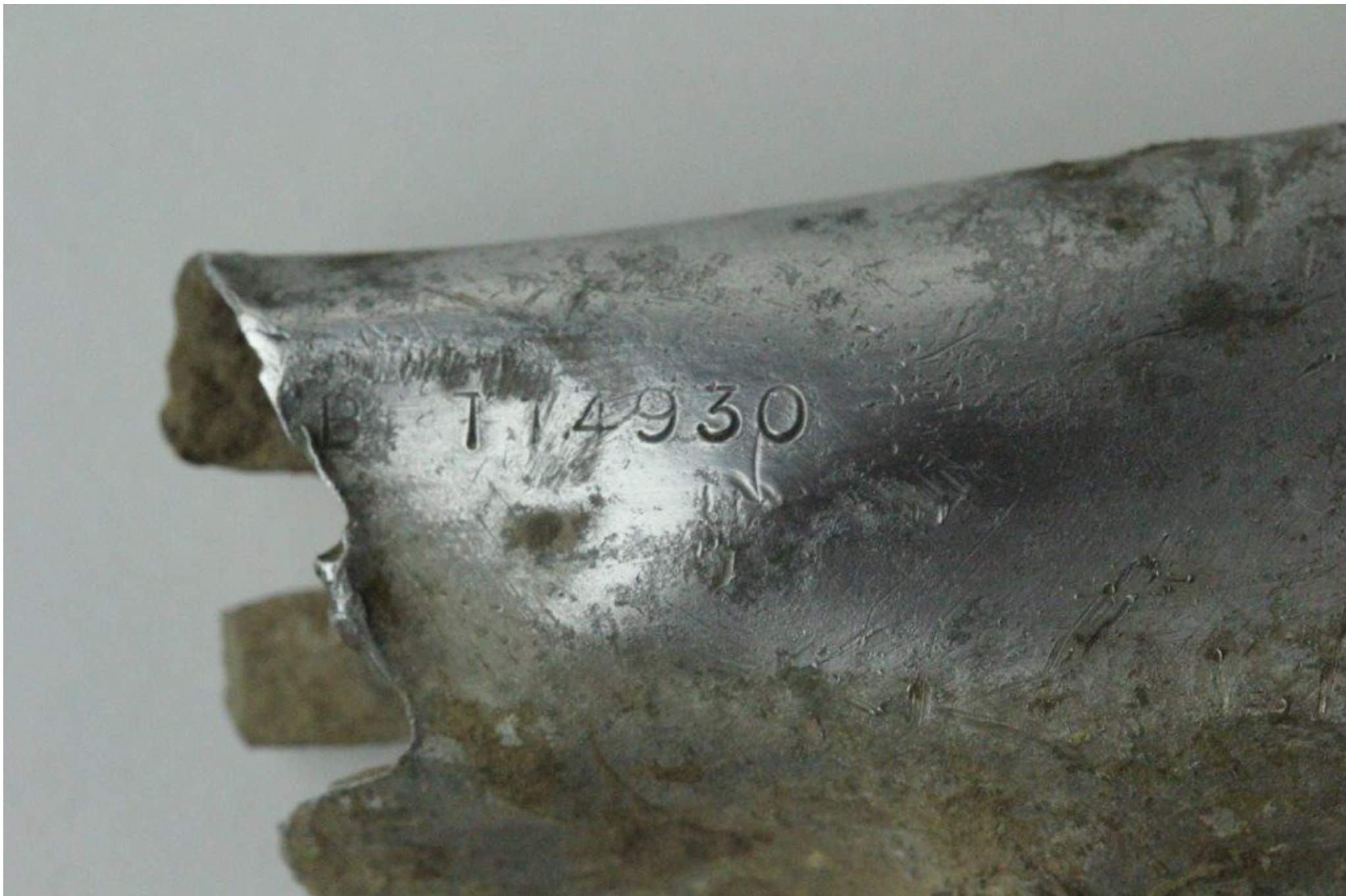
Aluminiumsstykke med fabrikationsnumre/inspektionsstempler.
