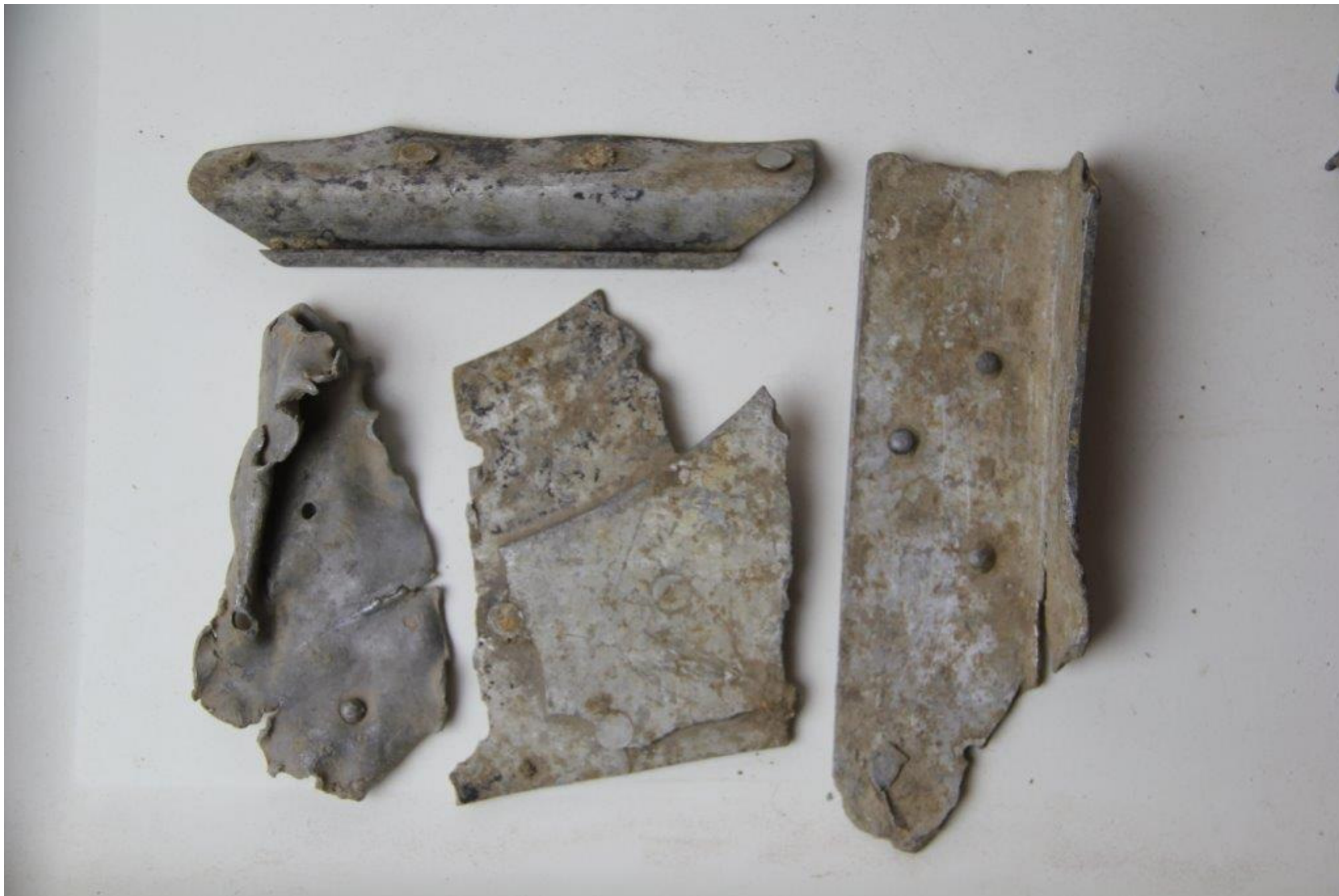
Vragdelsfelt 1: Nærbillede af nittede aluminiumsplader.
