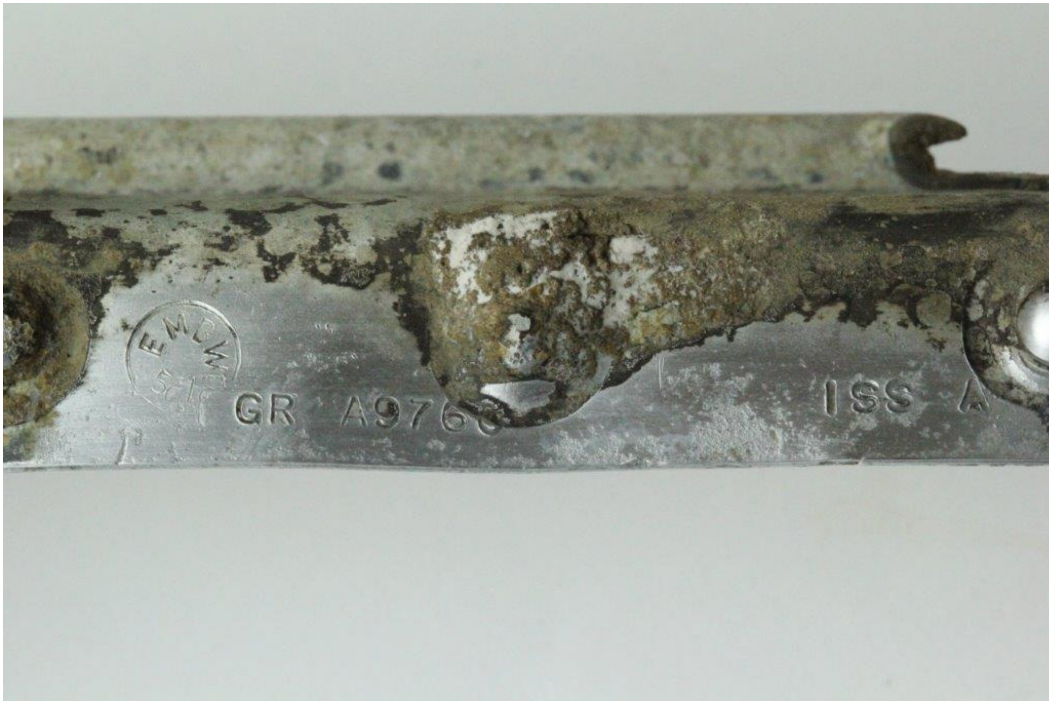
Aluminiumsstykke med fabrikationsnumre/inspektionsstempler.
