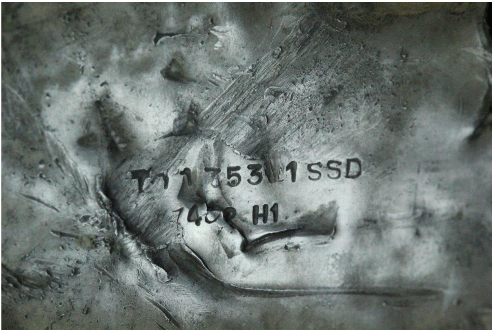
Aluminiumsstykke med fabriktionsnumre/inspektionsstempler.
